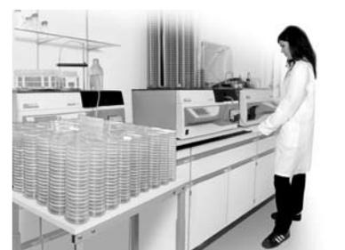
traditionnels. Pour une qualité constante de boîtes d'agar, il est nécessaire de maintenir un environnement propre pendant l'opération de distribution. La surface de la chambre de remplissage du MEDIAJET est fabriquée d'une pièce en polyéthylène résistant aux agressions chimiques, permettant un nettoyage aisé et efficace. De plus, une puissante lampe UV fournit un effet bactéricide optimal sur toute la surface du rotor à l'endroit d'ouverture des boîtes lors de la distribution.
